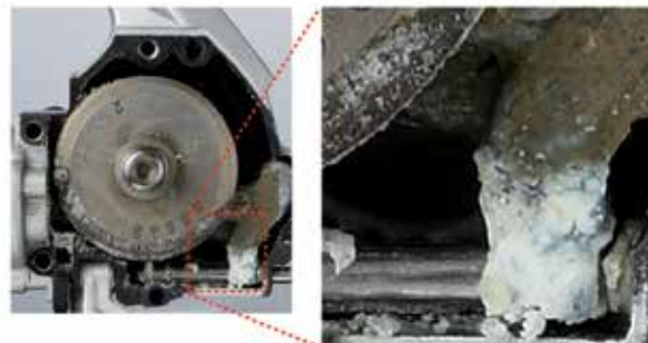
Usporedba rola sa i bez Mag Sealed. Izvor: DAIWA Intern. Service Dept.
